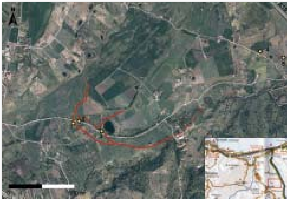
Figura 2.2.8 Ortofoto dell'area interessata dal movimento franoso e ubicazione delle fratture e dei principali danni alle strutture antropiche.
