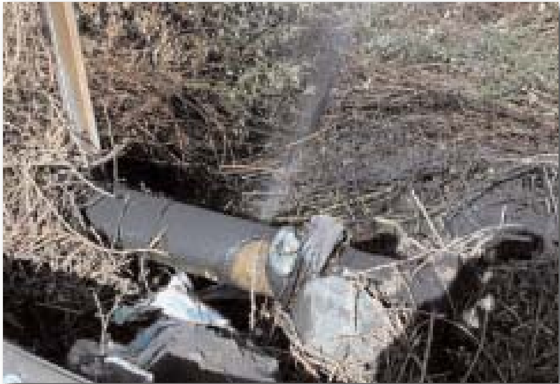
Figura 2.3.10: Rottura delle condutture idriche in corrispondenza del cavalcavia dell'autostrada posta tra Linera e Guardia.
